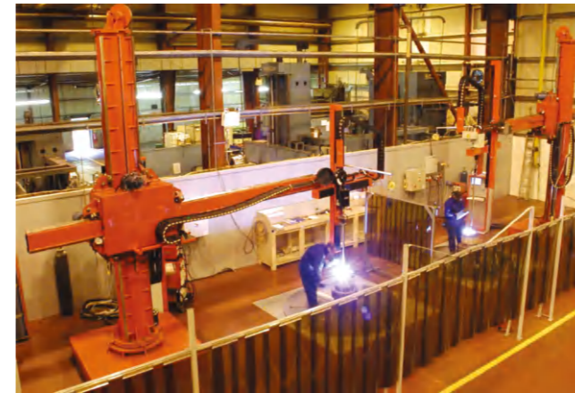
内壁焊机 Inner wall welding manipulator
